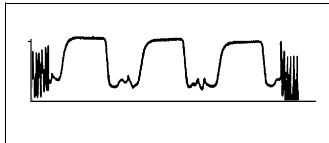
Fig 14- Reinalação de CO 2 : falha de válvula unidirecional ou esgotamento do sistema de absorção.
